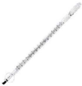
**ТЛС-2 – Термометр жидкостный**
