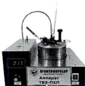
Аппарат ПромХимПрибор ТВЗ-ПХП - это прибор в соответствии с ГОСТ 6356, позволяющий методику определения температуры вспышки нефтепродуктов в закрытом терметинном тигле. Прибор ТВЗ-ПХП соответствует также методике тестирования ISO 2719. Прибор ТВЗ-ПХП предназначен для определения температуры вспышки нефтепродуктов, нагреваемых с установленной скоростью в закрытом терметинном тигле, в условиях испытания над...
